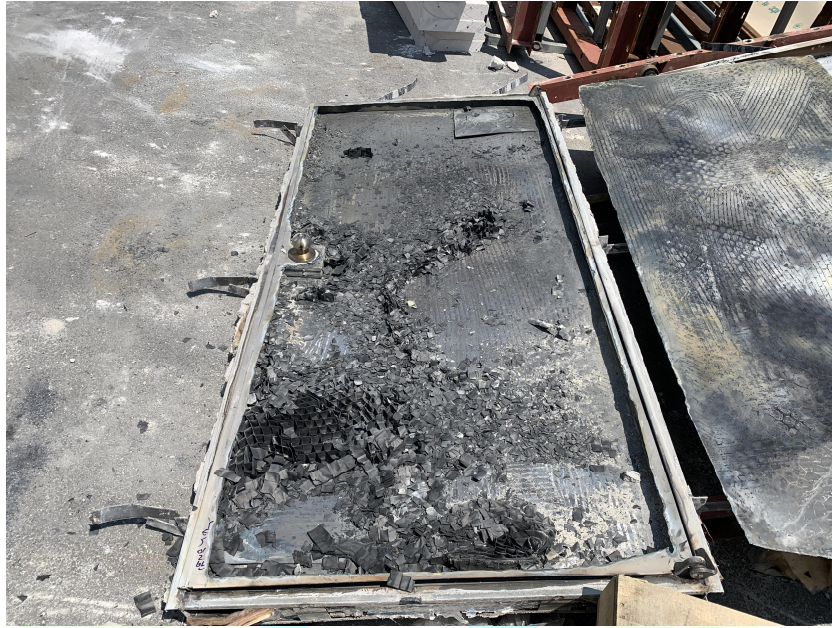
< 가열종료 후 시험체 내부 >
