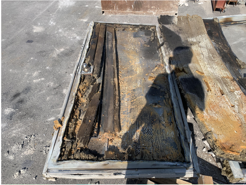
< 가열종료 후 시험체 내부 >
