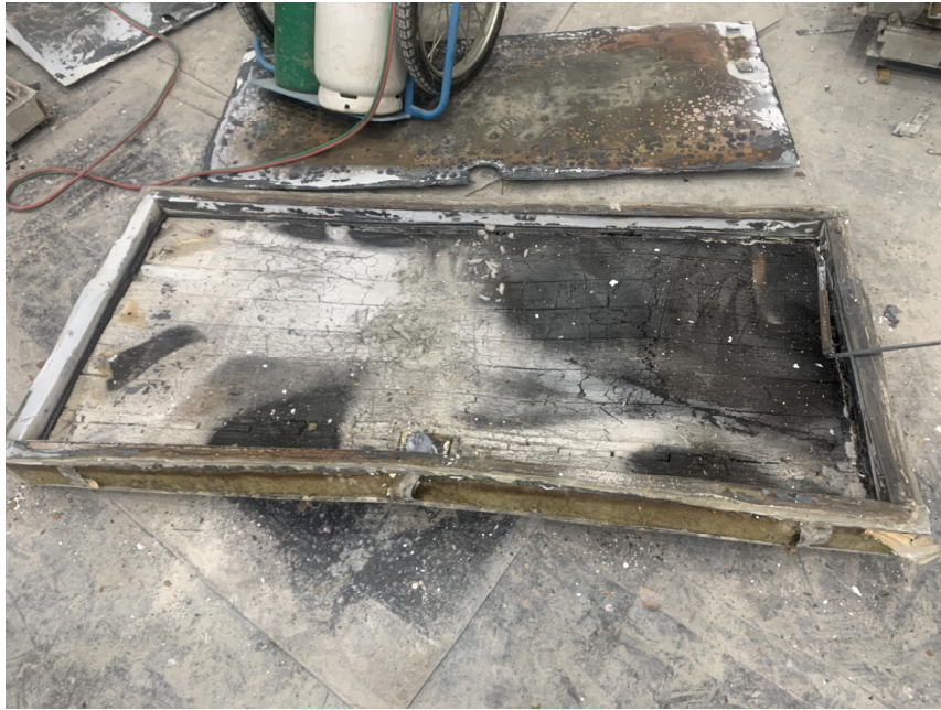
< 가열종료 후 시험체 내부 >
