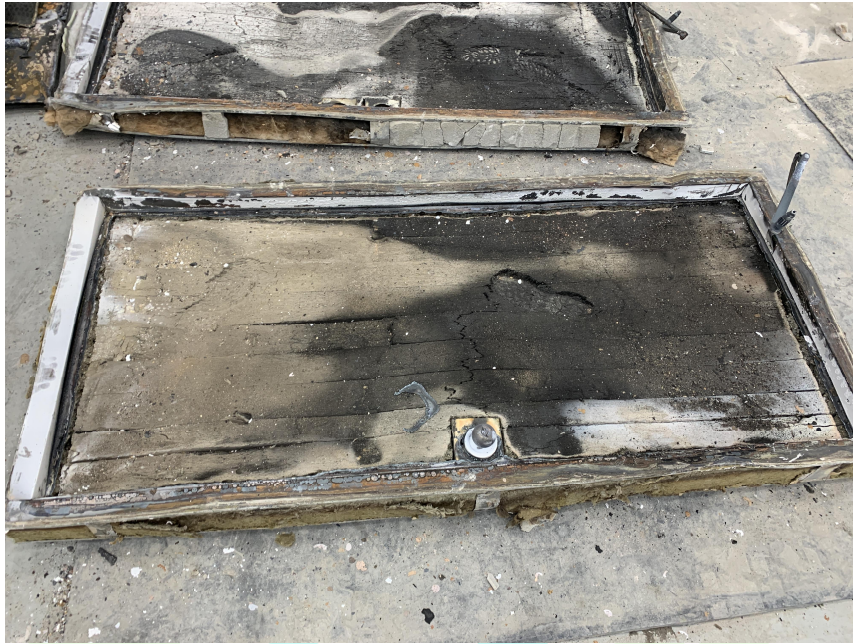
< 가열종료 후 시험체 내부 >
