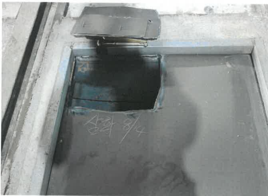
가열종료후 시험체 내부(도어클로저 부위) 모습
