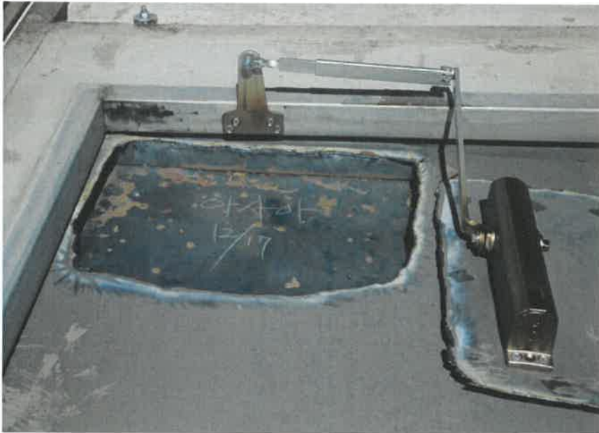
가열종료후 시험체 내부(도어클로저 부위) 모습
