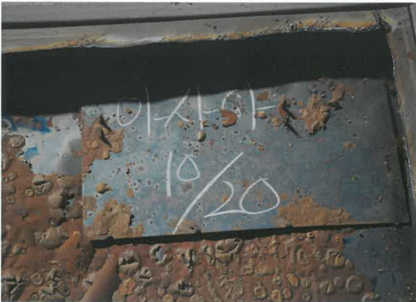
가열종료후 시험체 내부(도어클로저 부위) 모습
