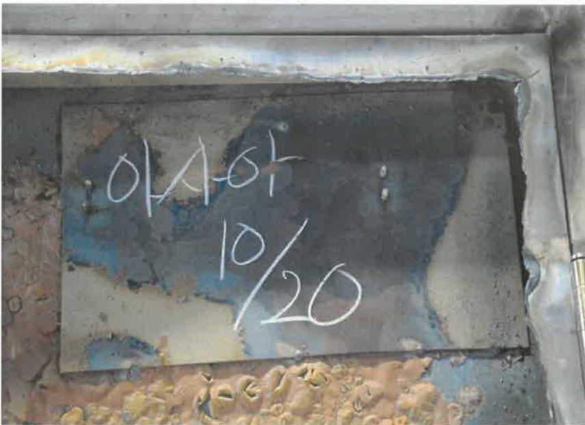
가열종료후 시험체 내부(도어클로저 부위) 모습
